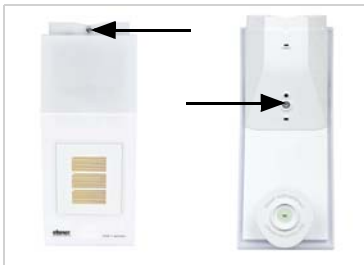
Abb. 16 Verschrauben Sie Deckel (oben) und Unterteil (unten).
